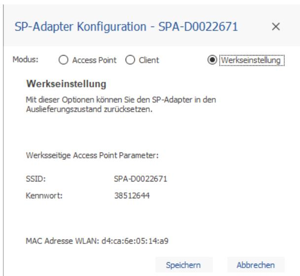
Diese Maske können Sie auch informativ verwenden, falls Sie das WLAN-Kennwort vergessen haben und der Aufkleber mit dem Kennwort an der Rückseite des SP-Adapters nicht mehr lesbar ist. Drücken Sie dann bitte auf die Schaltfläche 'Abbrechen' um die Konfiguration des SP-Adapters unverändert zu belassen.
